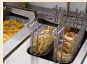
Sistema de elevación automática de cestos
